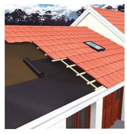
**Sika® Lámina Asfáltica**, es un producto prefabricado a base de asfalto modificado con polímeros y estructurada con polietileno de alta flexibilidad. Es recomendado para el mantenimiento del sistema de impermeabilización multicapa.
