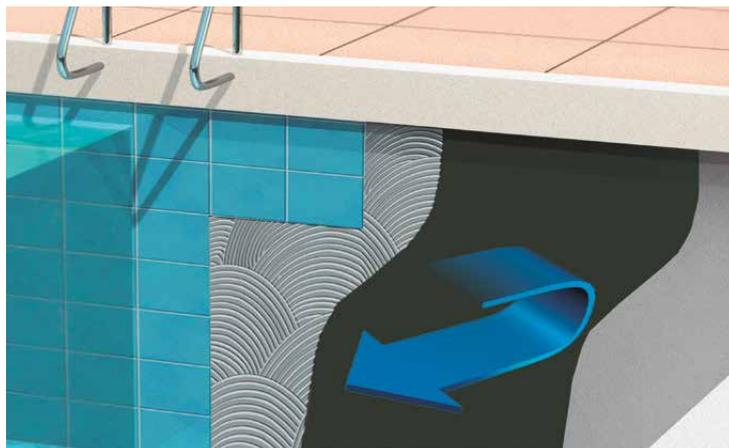
**SikaTop® 107 Flex** es un revestimiento impermeable flexible de dos componentes, no tóxico a base de cemento modificados con polímeros.
