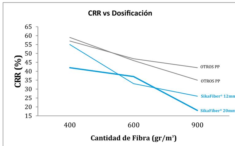
CRR, índice que mide la ruptura, el grado en que la fibra elimina la fisuración del hormigón. A menor índice mejor performance.
