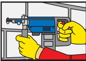
Perforar el agujero con un taladro eléctrico al diámetro y profundidad requerida. El diámetro del orificio debe estar de acuerdo con el tamaño del anclaje.
