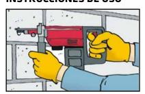
1. Realice la perforación con un taladro con el diámetro y profundidad deseados. El diámetro de la perforación debe ser de acuerdo al tamaño del anclaje para evitar desperdicios.
