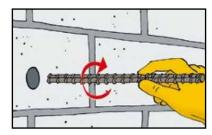
Inserte el anclaje haciendo un movimiento rotatorio en la perforación. Debe colocar el anclaje durante el tiempo abierto del adhesivo.
