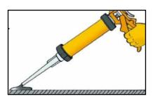
Presione el gatillo de la pistola hasta que salga el adhesivo con consistencia y color uniforme. No use el material inicial que se haya mezclado bien.
