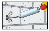
3. Después de cada ciclo de limpieza, limpie la perforación con una aspiradora o sople con un compresor o bomba manual de aire.
